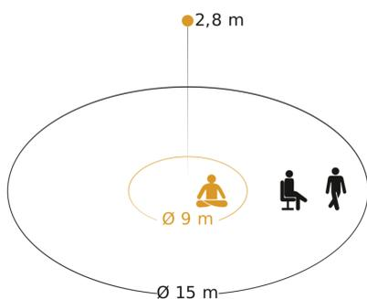
Possibile altezza di montaggio: 2,00 m - 12,00 m
